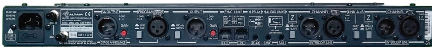
Tyłny panel WBS-202 zajmują wszelakie gniazda, w tym zdublowane z tymi na panelu czołowym gniazda antenowe.
