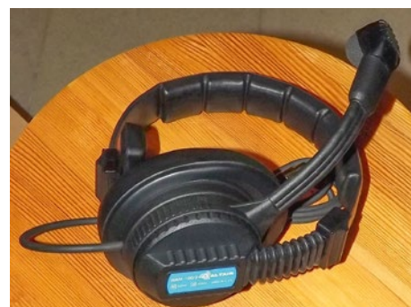
Jednuszynny zestaw słuchawkowo-mikrofonowy WAM-100/2S (dostępna jest też wersja dwuszynna) dysponuje słuchawką zamkniętą oraz mikrofonem na regulowanym wysięgniku.
