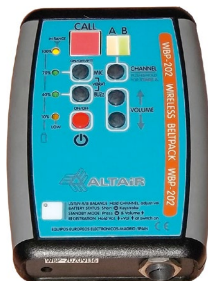
Standardowy nadajnik/odbiornik bezprzewodowy – w tym przypadku jest to dwukanałowe urządzenie typu „manager” WBP-202.
