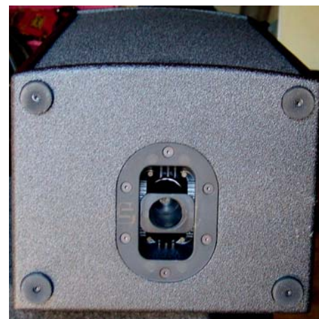
Dolna ścianka PA 212-500 została wyposażona w gumowe nogi oraz gniazdo statywu o zmiennym kącie pochylecia.
