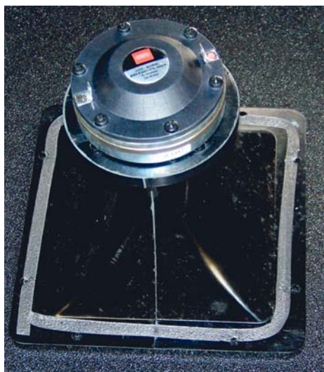
Driver zestawu szerokopasmowego to produkt firmy BMS, o symbolu 4532 i średnicy wylotu 1" oraz impedancji 8 omów.
