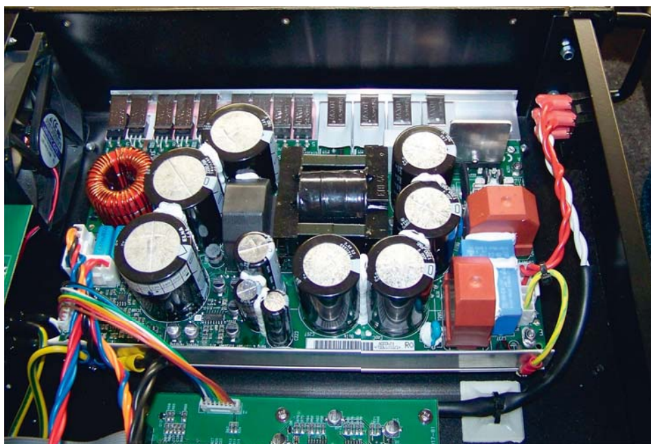
Moduł zasilacza impulsowego jest na wspólnej płycie z końcówką mocy kanału basowego.
