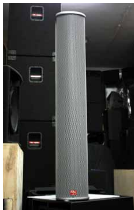
LA 120 – kolumna emitująca falę cylindryczną, oparta na przetwornikach wstęgowych (z bardzo ciekawej serii LA). Świetnie sprawdza się przy ekranach projekcyjnych, w zastosowaniach konferencyjnych i innych aplikacjach nie wymagających wysokich poziomów SPL.
