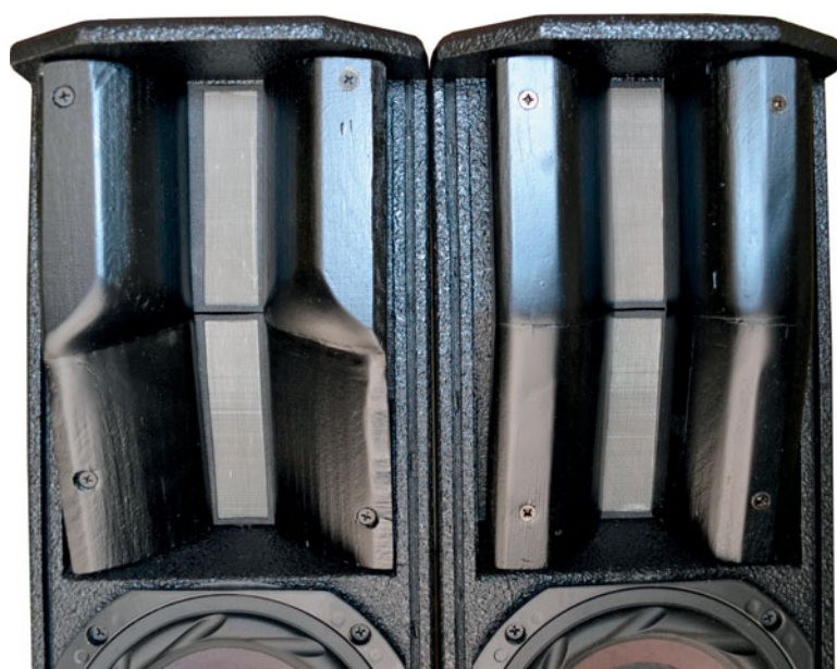
Jeden model L-32 oferuje jednolity kąt dyspersji w poziomie równy 80°, zaś drugi (z lewej) charakteryzuje się asymetryczną dyspersją – 80° (driver górny) i 100° (driver dolny).
