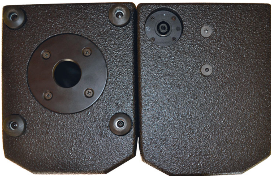
Na dolnej ścianie zamontowano cztery gumowe podstawki oraz gniazdo statywu, zaś na górnej zainstalowano jeszcze jedno gniazdo Speakon.
