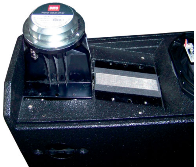
Zestaw wyposażony został dwa driversy planarne BMS-a, dzięki czemu emitowane przez nie fale charakteryzują się płaskim czołem.
