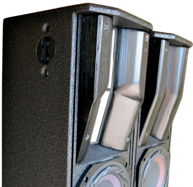
Aby poszerzyć kąt promieniowania L-32 w płaszczyźnie pionowej dolny driver zestawu pochylony jest w dół około 20 stopni.
