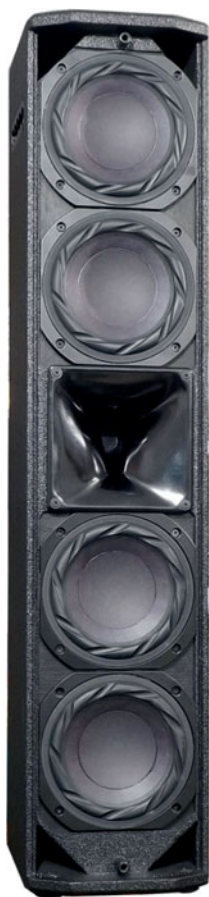
L41-600 zbudowany jest w oparciu o cztery głośniki 18Sound o średnicy 6 cali oraz driver, umieszczony w środku, pomiędzy parami wooferów.
