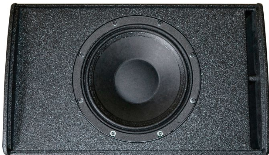
Po zdjęciu osłony oczom naszym ukazuje się jeden centralnie umieszczony głośnik – niechybny znak, że jest to konstrukcja z przetwornikiem współosiowym w obudowie bass-reflex (kanał wylotowy widoczny z prawej strony).
