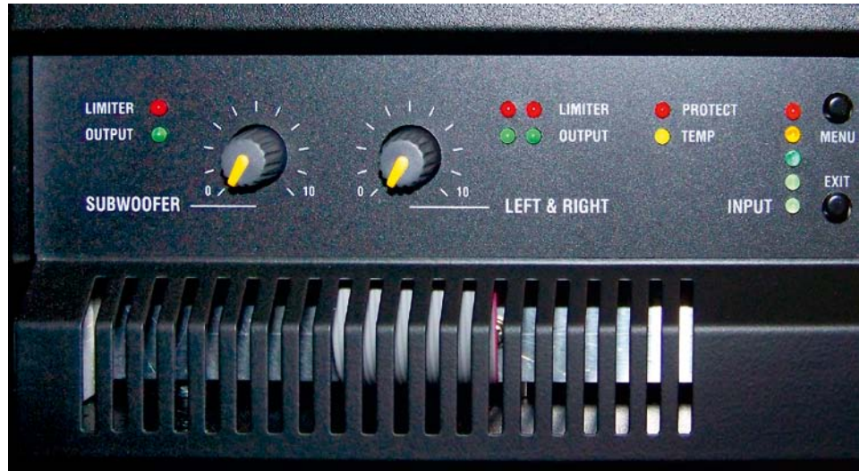
Na panelu czołowym umieszczono dwa potencjometry, obok których znajdują się diody LED sygnalizujące obecność sygnału i zadziałanie limiterów – dla każdego z wyjść osobno.
