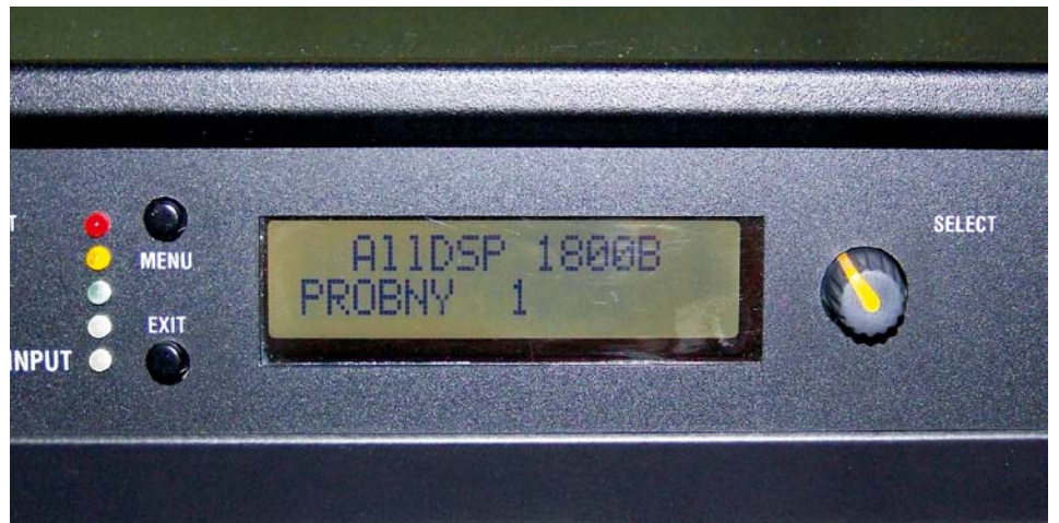
W centralnej części przedniego panelu zamontowano dwulinijkowy, tekstowy wyświetlacz LCD, a obok dwa przyciski oraz obrotowy enkoder służące do nawigacji i zmiany ustawień menu.
