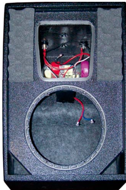
Wewnątrz każdej z obudów widać rozpórkę wiążącą przód i tył obudowy oraz materiał wyłumiający.
