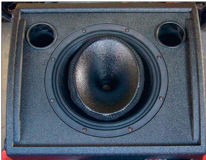
W obu monitorach głośnik zamontowano z takim ustawieniem tuby drivera, aby promieniował dźwięk pod większym kątem w pionie.
