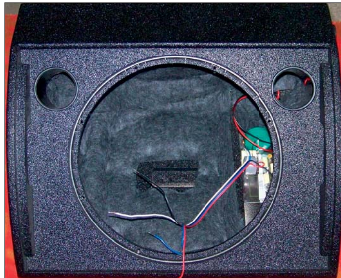
Wewnątrz monitory wykonane są równie perfekcyjnie, jak z zewnątrz – po odkręceniu głośnika widać wytłumienie wewnątrz obudowy oraz filtr, który rozdziela sygnał pomiędzy przetworniki.
