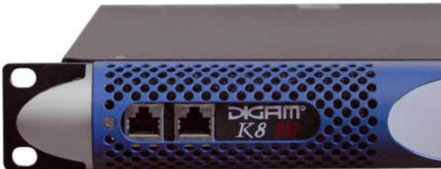
Z lewej strony panelu przedniego umieszczone zostały gniazda Ethernet, przy pomocy których możemy zdalnie monitorować pracę wzmacniaczy.
